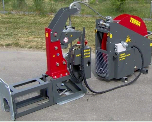
Travaux sans tranchée par éclatement Remplacement d'une conduite sans ouvrir la chaussée. Extracteur 40 tonnes.
